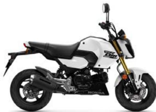
220 mm à frente com pinça de dois pistões e ABS e um disco de 190 mm atrás.
