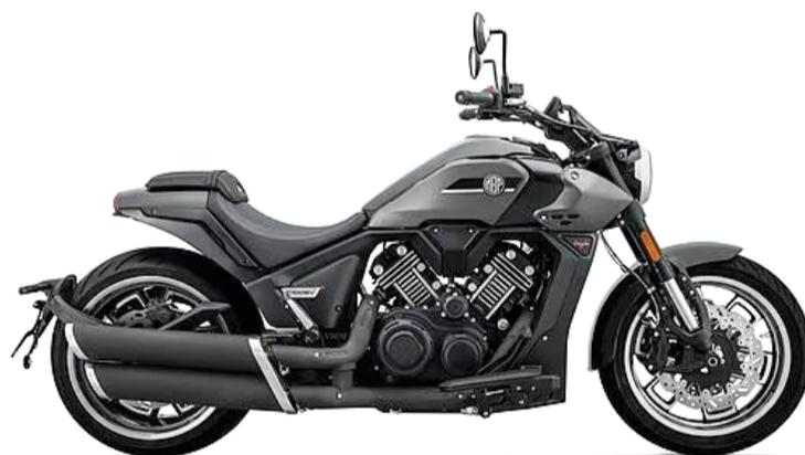
lo e design, a C1002V. A designação vem do seu impressionante motor de dois cilindros em V, com uma cilindrada de 997 cc, debitando 87,2 cv de potência e 89 Nm de binário. Esta força permite-lhe uma fantástica resposta e acelerações emocionantes. Dois discos de travão com 320mm na roda dianteira e um na roda traseira de 300mm e tudo com ABS, conferem-lhe uma excelente capacidade de travagem.
