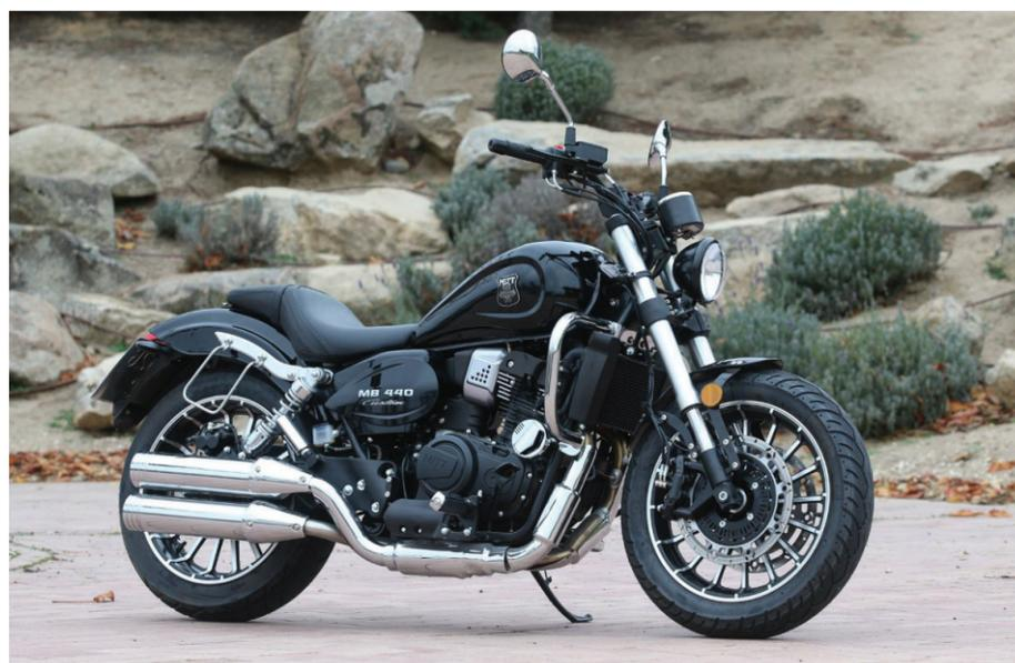
O motor é um bicilíndrico de 389cc refrigerado por líquido, com uma potência máxima de 35 cv e um binário de 33 Nm. Mostra-se muito progressivo e arredonda-
